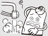
**4** 元止め式の瞬間湯沸器や元止め式の電気温水器のついている水栓には接続しないでください。
