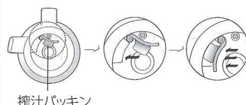
搾汁パッキンがドラム裏面に確実にセットされていることを確認してください。
