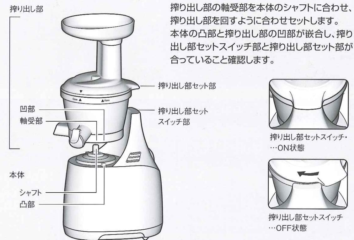
※搾り出し部セットスイッチ部と搾り出し部セット部がずれていたり、隙間(段差)があると、正常に動作しません。
