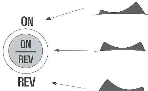
● 使用中、スクリューが停止した場合は、操作スイッチの「REV」を押し、スクリューに溜まっている食材を移動させてから「ON」スイッチを押してください。この際、逆回転が完全に停止してから「正回転」スイッチを押してください。
