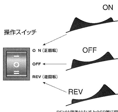
●使用中、急にスクリューが停止した場合は、操作スイッチを「OFF」にしてから「REV」を押し、スクリューに溜まっている食材を後ろに移動させてから「ON」スイッチを押してください。この際、逆回転が完全に停止してから「ON」スイッチを押してください。
