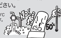
**4** 元止め式の瞬間湯沸器や元止め式の電気温水器についている水栓には接続しないでください。
